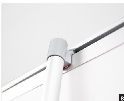
Setzen Sie die Klemmschiene langsam und vorsichtig auf die Stützstange und drehen Sie die Klemmleiste dabei leicht in Richtung der Stützstange. Achten Sie darauf, dass die Stützstange genau auf dem an der Klemmleiste angebrachten Pfeil sitzt.
